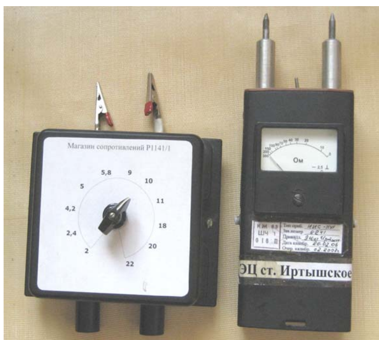
Прибор ИИС-1142 с магазином сопротивлений Р1141/1 для проведения калибровки ( 2,0 – 22,0 Ом)
